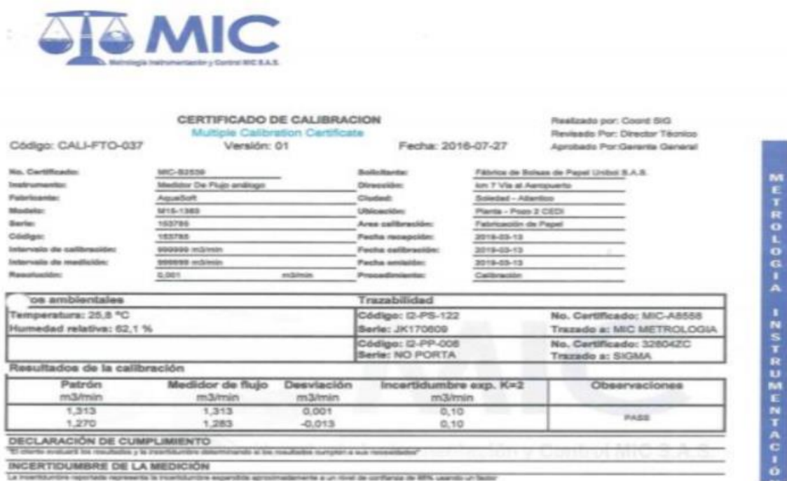
Figura 6. Calibración de Medidores o Contadores de Agua Captada
